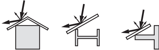
插图. 15: 用散射挡板来覆盖光滑的型材
