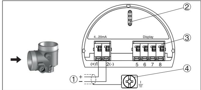
Abb. 8: Anschlussraum - Zweikammergehäuse
