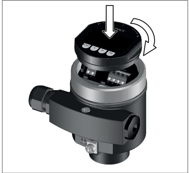
插图. 6: 将显示和调整模块装入单腔式壳体的电子部件腔中
