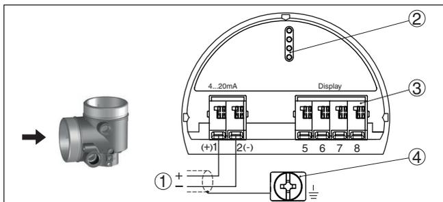
Fig. 5: Compartiment de raccordement - boîtier à deux chambres
