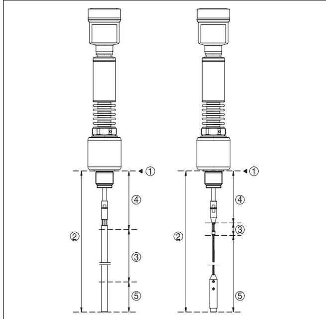
Fig. 11: Faixas de medição - NivoGuide 8200
