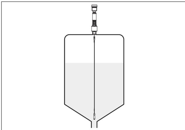
Fig. 2: Reservatório com fundo côncavo
