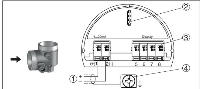
Fig. 8: Compartimento de conexão - Caixa de duas câmaras
