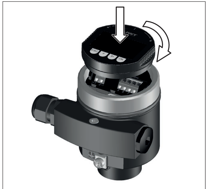
Fig. 18: Empleo del módulo de visualización y configuración en carcasa de una sola cámara el compartimento de conexión
