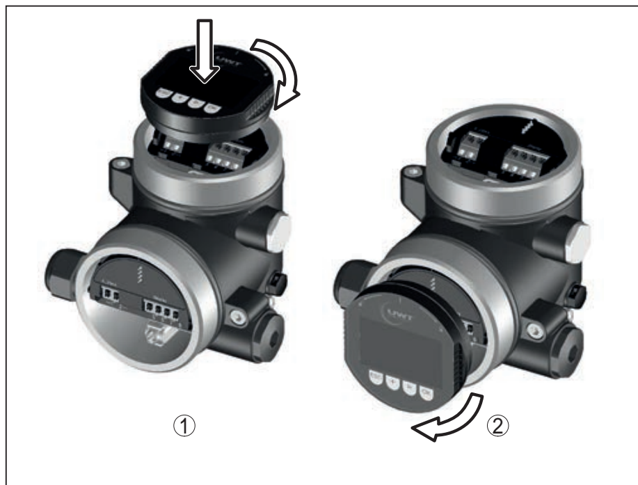
Рис. 11: Установка модуля индикации и настройки в двухкамерном корпусе
