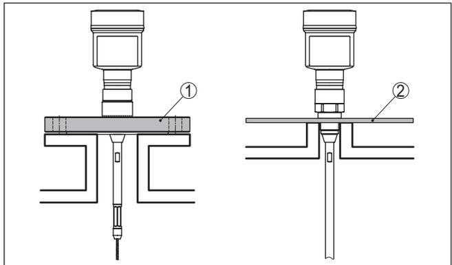
Fig. 3: Montage dans des cuves non métalliques
