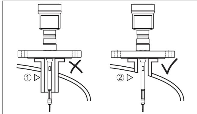
Fig. 5: Monter la rehausse de façon arasante
