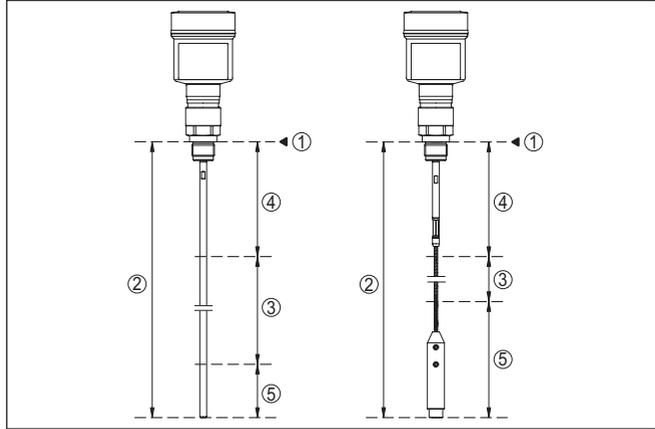
Fig. 11: Plages de mesure - NivoGuide 8100
