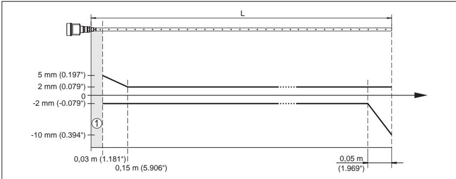
Fig. 26: Écart de mesure NivoGuide 8100 en version coaxiale dans le produit Eau
