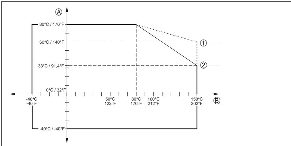
Fig. 28: Température ambiante - température process, version standard
