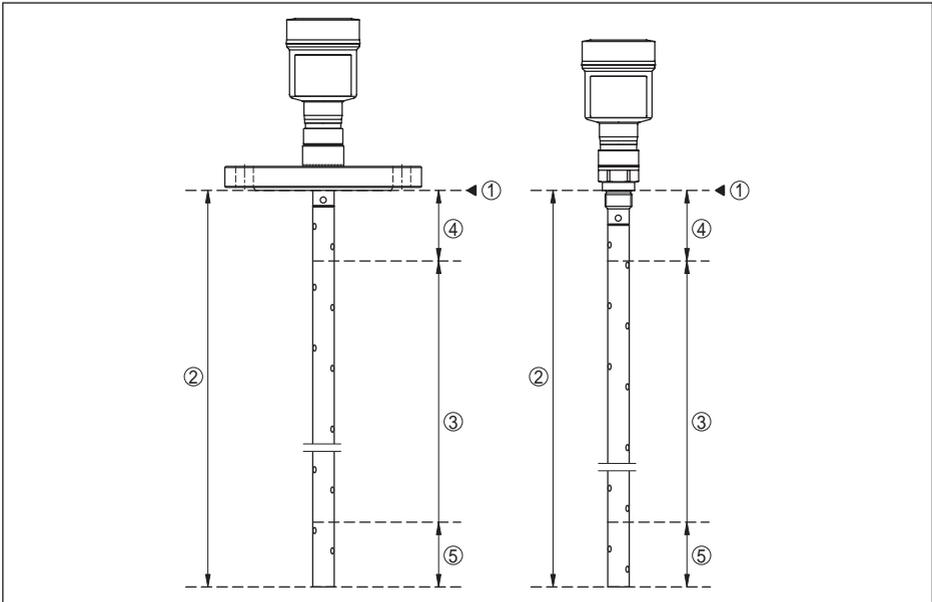
Fig. 25: Plages de mesure - NivoGuide 8100
