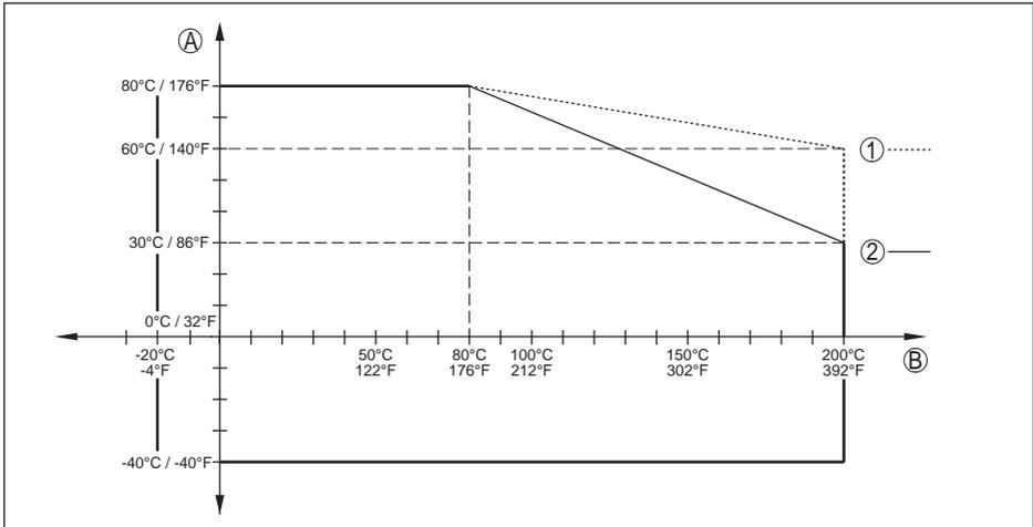
Fig. 29: Température ambiante - température process, version avec extension haute température
