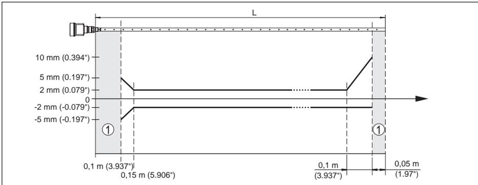
Fig. 27: Écart de mesure NivoGuide 8100 en version coaxiale dans le produit Huile
