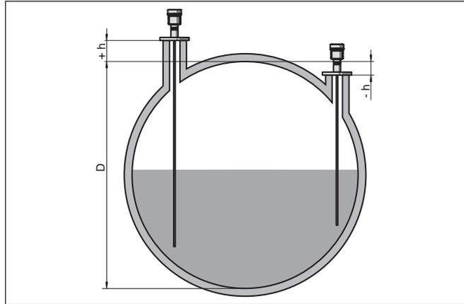
Fig. 14: Hauteur de la cuve et valeur de correction du manchon
