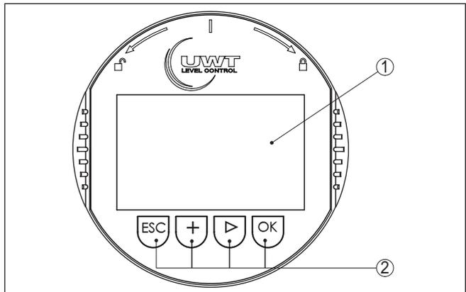
Fig. 13: Éléments de réglage et d'affichage
