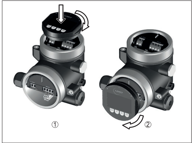
Fig. 19: Colocação do módulo de visualização e configuração na caixa de duas câmaras
