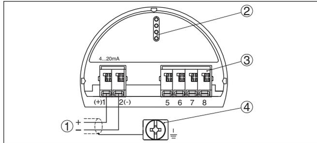
Рис. 15: Отсек электроники и подключения (однокамерный корпус)
