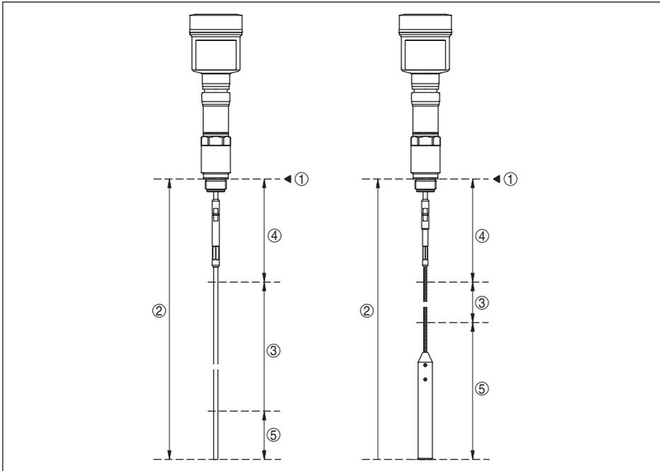
Рис. 26: Диапазоны измерения - NivoGuide 8200
