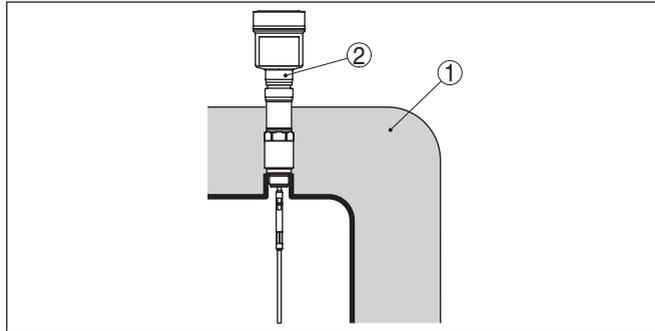
Рис. 11: Монтаж устройства на емкости с термоизоляцией
