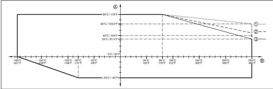
Рис. 32: Температура окружающей среды - температура процесса, стандартное исполнение
