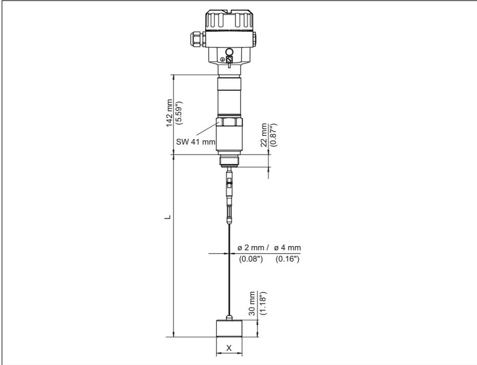
Рис. 38: NivoGuide 8200, резьбовое исполнение с центрирующим грузом
