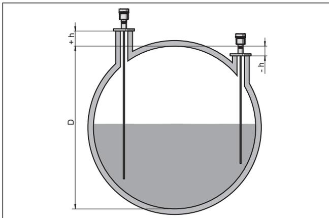
Рис. 21: Высота емкости и значение коррекции патрубка
