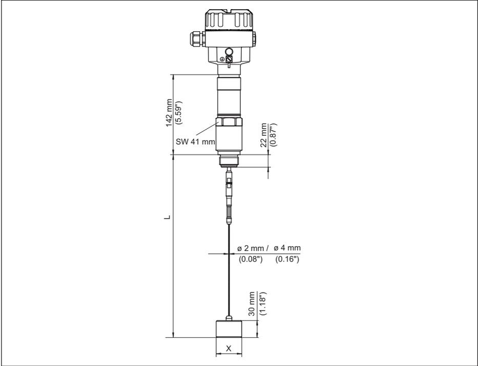
插图. 38: NivoGuide 8200, 带对中重量的螺纹型
