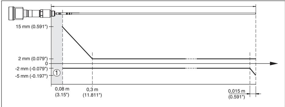
插图 27: 棒型 NivoGuide 8200 在介质“水”中的测量偏差
