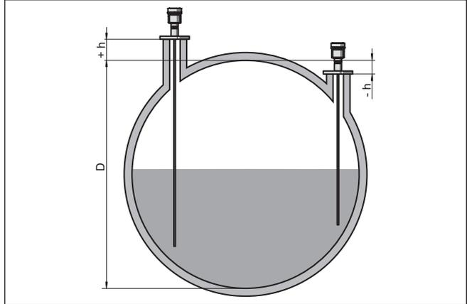
插图. 21: 容器高度和套管修正值
