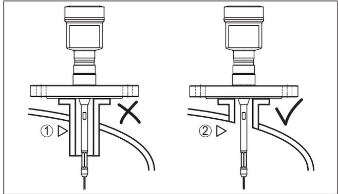
插图. 7: 齐平地安装管接头
