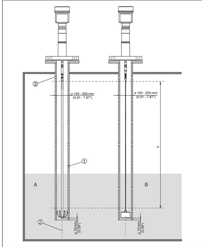
插图. 10: 安装在一根立管中
