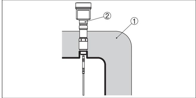
插图. 11: 将仪表安装在绝缘容器上。
