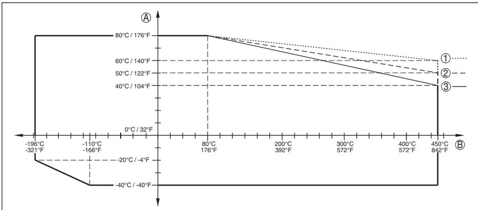
Fig. 30: Température ambiante - température process, version standard
