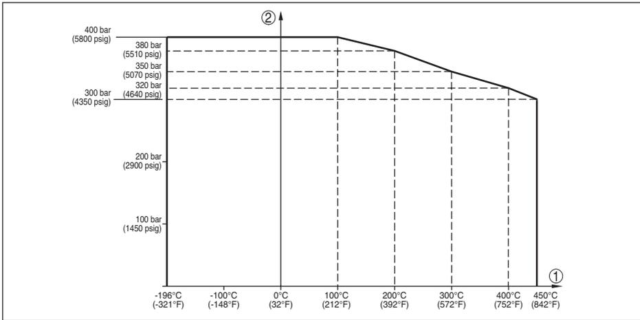
Fig. 32: Pression process - température du process (version -196 ... +450 °C/-321 ... +842 °F)
