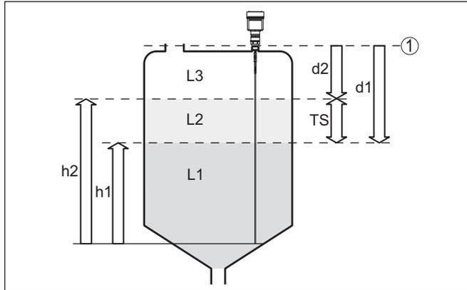
Fig. 3: Mesure d'interface
