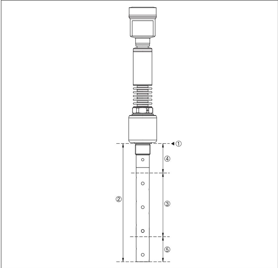
Fig. 24: Plages de mesure - NivoGuide 8200
