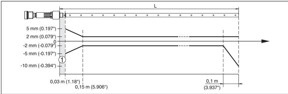
Fig. 25: Écart de mesure NivoGuide 8200 en version coaxiale dans l'eau (longueur de mesure jusqu'à 1,5 m/4.92 ft)
