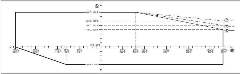
Fig. 29: Température ambiante - température process, version standard
