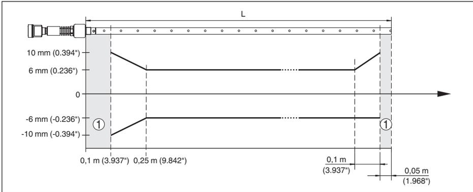
Fig. 28: Écart de mesure NivoGuide 8200 en version coaxiale dans l'huile (longueur de mesure jusqu'à 6 m/19.69 ft)
