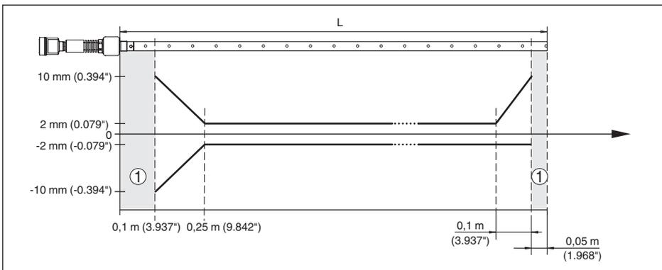
Fig. 27: Écart de mesure NivoGuide 8200 en version coaxiale dans l'huile (longueur de mesure jusqu'à 1,5 m/4.92 ft)
