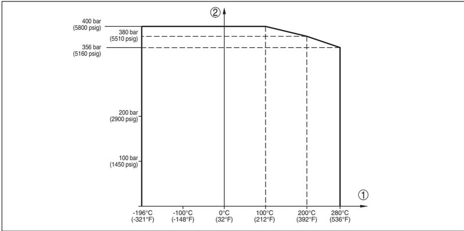
Fig. 31: Pression process - température du process (version -196 ... +280 °C/-321 ... +536 °F)
