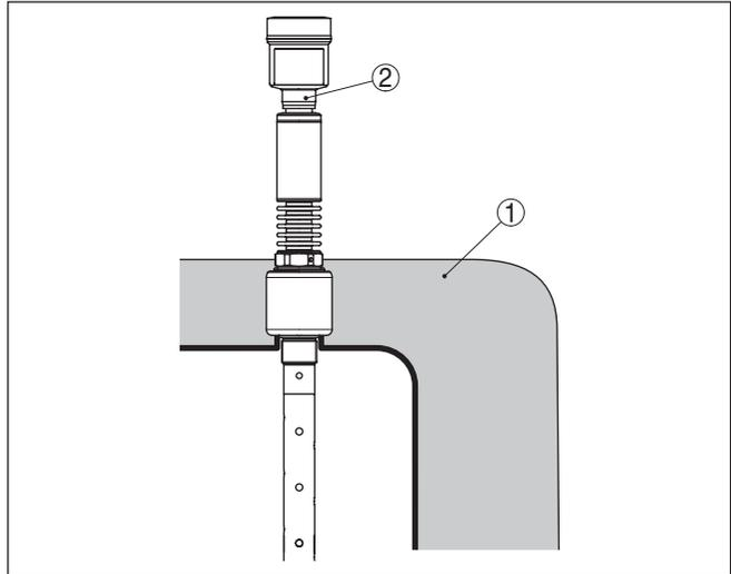
Fig. 7: Montage de l'appareil dans des cuves isolées
