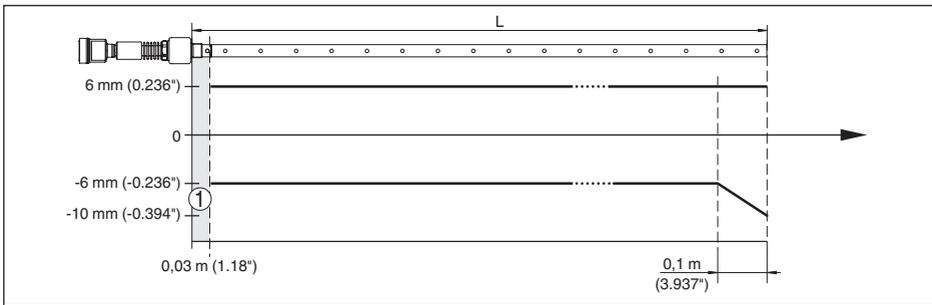
Fig. 26: Écart de mesure NivoGuide 8200 en version coaxiale dans l'eau (longueur de mesure jusqu'à 6 m/19.69 ft)
