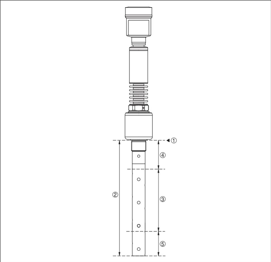
Fig. 19: Plages de mesure - NivoGuide 8200
